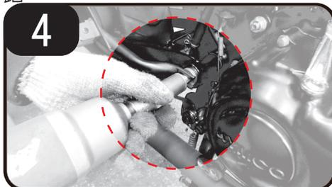
4 待原廠左右原廠前腳踏都取下後將，圖2放鬆羅姆鎖回(後座腳踏支架)
