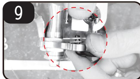
9 安裝右邊腳踏後移前，請先將煞車連桿安裝至右腳踏總成，並安裝固定銷
