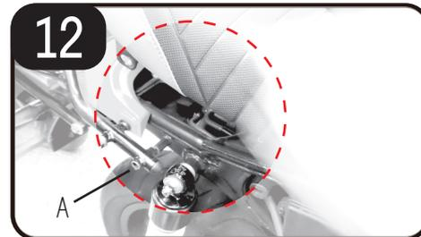
12 左右A處螺絲卸除，並將椅墊卸下
