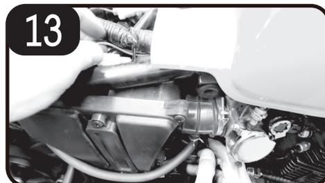
13 將煞車感應線拆下原廠支架，並重新拉線至適當位置以利於裝入WRRP煞車感應線支架
