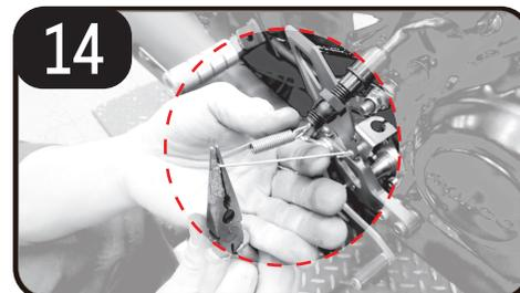
14 沿圖13步驟，修改原廠煞車彈簧長度並安裝於煞車感應線支架
