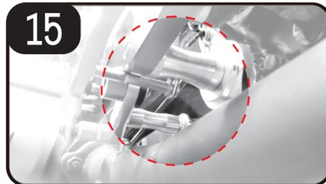
15 煞車感應線彈簧安裝位置圖，完成後確認螺絲皆已上緊
