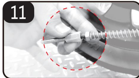
11 煞車連桿安裝上附件F煞車延長桿
