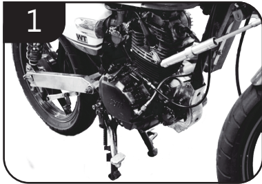
1 先將排氣管卸下
